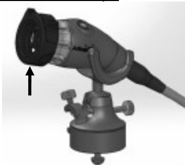
Рисунок 3. Демонтаж видеокамеры с монтажной опоры, с замковым соединением
