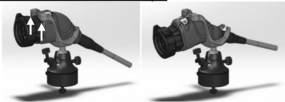
Рисунок 3. Демонтаж видеокамеры с монтажной опоры, с замковым соединением
