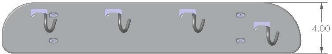
**NOTE: RH IV BAG HANGER IS NOT AVAILABLE DUE TO LOCATION OF ELECTRICAL CONNECTIONS.**
