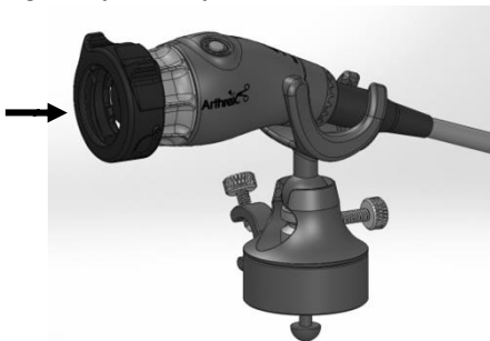
Rysunek 2: Instalacja kamery w zatrzasku mocowania kamery
