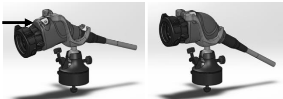
Afbeelding 2: de camera in de kliksluiting van de camerabevestiging installeren
