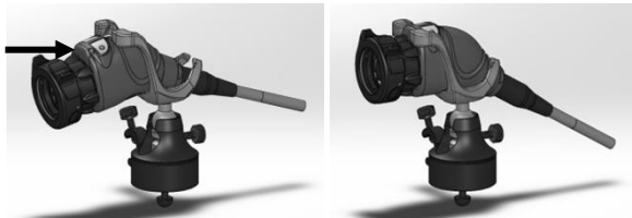
Figura 2: Instalación de la cámara en el soporte de ensamblado a presión
