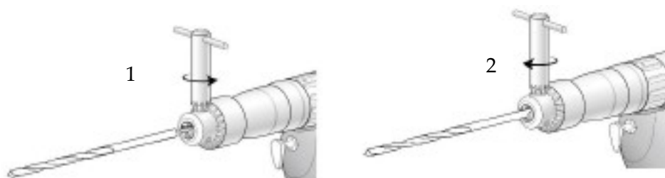
Figur 8 Isæt et borebit i en Jacobs chuck
