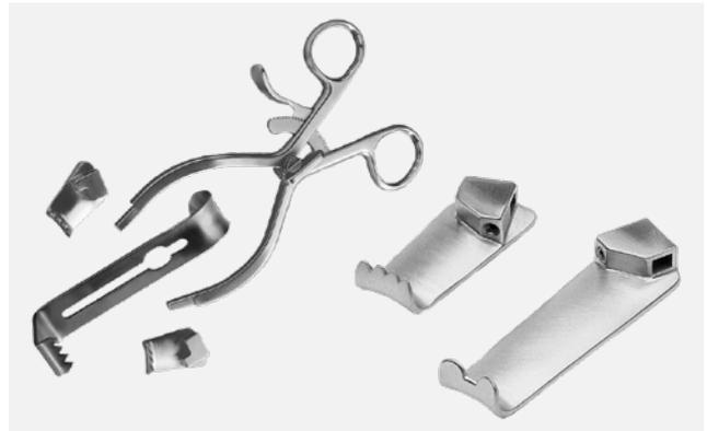
Der modulare Weichteilretraktor ist ein vielseitiges Zubehörteil für transmuskuläre Zugänge in der Schulter, einschließlich der minimal-offenen Rotatorenmanschettenrekonstruktion. Er ist selbstarretierend und selbsthaltend ausgeführt. Seine modularen Haken ermöglichen ein festes aber sicheres Freilegen. Durch die selbstarretierende Konstruktion kann die Schulter über die gesamte Bewegungsspanne frei bewegt werden, ohne dass der Retraktor disloziert.
